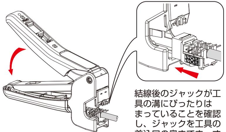
結線後のジャックが工具の溝にぴったりはまっていることを確認し、ジャックを工具の差込口の奥までまっすぐに差し込みます。
