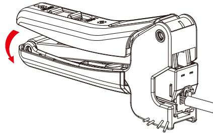
ケーブルを圧接し、切断するまでハンドルを握ってください。切断後のケーブルは取り除いてください。
