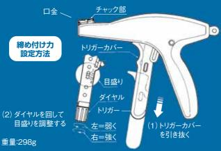
トリガーカバーを下へ引き抜き、トリガー先端にあるダイヤルを回し目盛りを設定します。右へ回すと締め付け力が強くなり、左へ回すと弱くなります。 ⚠チャック部やトリガー部で指をはさまないよう気をつけてください。
