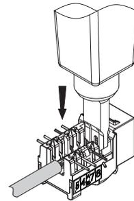
市販の110ブロック規格対応パンチダウン工具を利用して圧接と切断をしてください。
