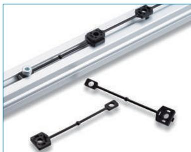
アルミフレームスロットなどの狭い場所に、ネジを使って固定するアタッチメントです。ESD135M(P7)をつなげてフレームスロットの隙間を埋めることができ、ワッシャ、ネジもサイズ変更なくそのまま使用して、接地までの取付け作業をスムーズに行うことができます。
