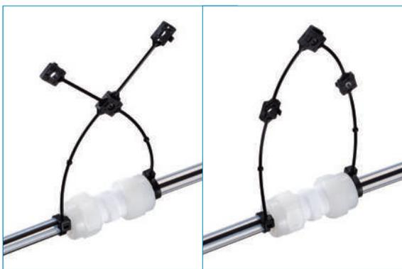
流体ホースを結束し、タイ同士を繋ぐことで、静電気を導通させることができます。また、タイの先端をネジ止めて接地(アース)させ、静電気を除去することも可能です。
