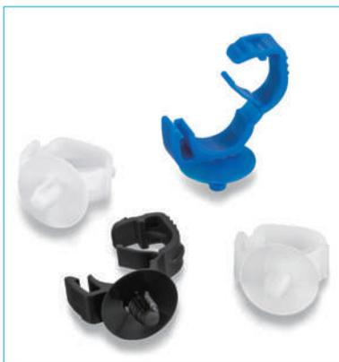
ドーム型の支えが付いているため、パネルに取り付けた後も安定した固定ができ、埃などが侵入しにくい形状です。クリップ部は開閉できるデザインのため、メンテナンス時にハーネスを動かしたり、取り外すことも可能です。マウント部のデザインは、ヘラマウントン独自のファーツリー(もみの木)形状を採用しており、1種類で幅広い範囲の板厚に対応します。
