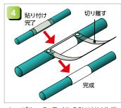
ケーブルへの、ラベルの貼り付け作業 が完了したら、暫定的に貼り付けたフ チ外周を軽く引っ張るように切り離す と、自由に動かせるラベル本体が残り、 完成です\*1。
