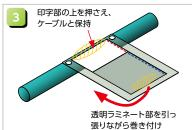
ラベル上端を押さえてケーブルと保持し透明 ラミネート部の下端を引っ張りながら、ケーブ ルへ巻き付けるように貼り付けます。その時 に印字部の横側(赤い点線)とラミネート部の 横側(青い点線)を重ね合わせるように巻き付 けると、きれいに貼り付けられます。
