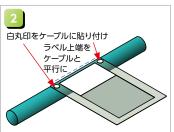
ケーブルを真っ直ぐにして、ラベル上端 をケーブルと平行にしながら、左右の 白丸印を押さえるようにして、ケーブルへ しっかり貼り付けます。
