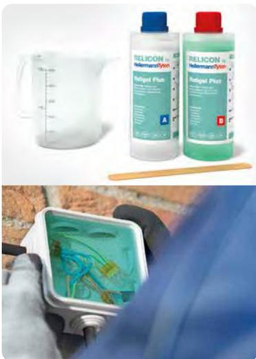
レリジェルは、解体可能な絶縁防水レジンを、二液を混合することでゲル化（ゼリー状に凝固）します。接続ボックス内の絶縁防水や防湿防塵にご利用いただけます。約12分（気温約23℃の場合）でゲル化します。ゲル化後は、手で解体可能です。内部が見やすい、透明性の高い製品です。
