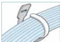
1. 先端をヘッド部の穴を通して締め付けます。
