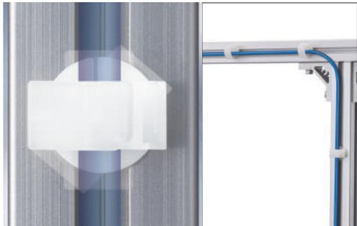
生産現場の設備ユニットのアルミフレームへ取り付け、簡単に配線固定が可能です。主要アルミフレームメーカー3社(SUS、MISUMI、ポッシュ・レックスロス)\*1製のアルミフレームに使用でき、汎用性に優れています。クリップ部は開閉できるデザインのため、メンテナンス時にハーネスを動かしたり、取り外すことが可能です。結束径がφ2mm~φ8mmのため、細径の配線固定に適しています。コンパクトな外形寸法で、フレームカバーなどに干渉しにくい設計です。
