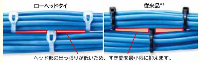
結束バンドの中で、ヘッド部の高さが最も低く抑えられたことにより、複数のハーネス束をまとめる際にも、ヘッド部が干渉しにくく、ワイヤーハーネス全体の径のコンパクト化に貢献します。
