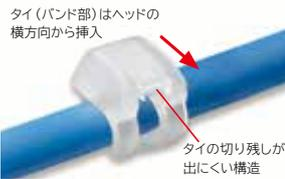
結束・切断後のタイ（バンド部）の切り残しが出にくい独自のヘッド構造を採用。また、タイの切り残しが上向きではなく、ヘッドの横方向からなるため、周辺の電線被覆や作業者を傷つけない、安全設計です。
