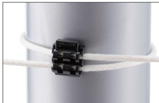
片方のロープ(上側)を「▷」形の爪が示す方向に引っ張っていくと締め込むことができます。
