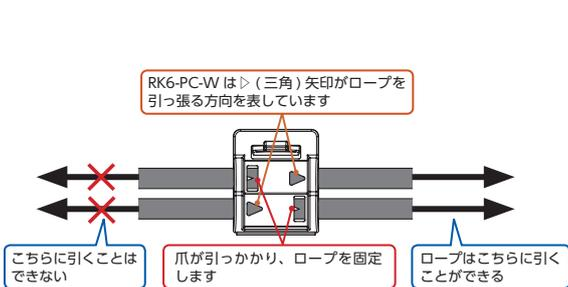
ジザイフィックス内側の爪がロープに引っかかり、一方向にしか引けない構造を利用して、ロープを固定します。
