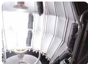
耐候性促進試験機内取り付け状態 ※写真は試験機のイメージです。
