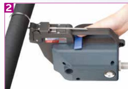
テンションノブを調整し、締め付け力を設定してください。
