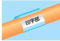
印字部は透明ラミネートで覆われ、汚れや溶剤から印字内容を保護するセルフラミネートタイプです。レーザープリンターで簡単に印字できます。長期間の耐候性を有するため、通信、建機、住宅、一般工事など屋外での配線識別に使用できます。
