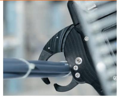
全自動結束システムの新モデル「AT2000CPKHB」などでご使用いただけるAT2000シリーズ用連結タイは、標準グレードのほか、耐熱、耐熱・耐候、難燃グレードなどの各種グレードをラインアップしており、ハンディ式でお使いいただける50本連結タイプと据え置きや吊り下げでお使いいただける5,000本連結タイプがあります。専用のオプションでは、フットペダルでの操作が可能で、両手を使って結束作業ができる据え置き台や、自由な動きで、長時間の連続作業が可能な吊下げ台（オーバーヘッドサスペンダー）などがあり、お客様の使用環境に合わせて快適にお使いいただけます。
