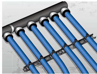
水道、ガスホースなどの配管固定
