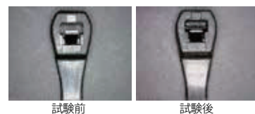
耐塩化カルシウム試験後の外観
